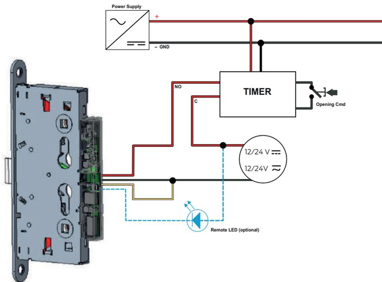
In questa configurazione di montaggio, la segnalazione luminosa (LED) risulterà VERDE o SPENTA, secondo lo schema
