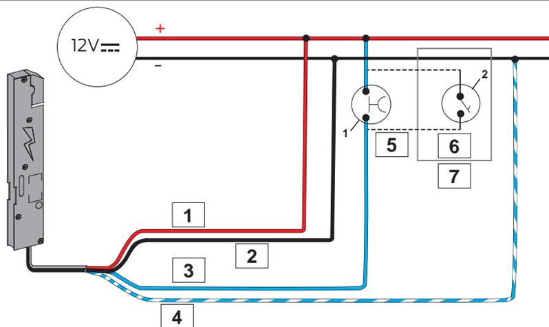
**Schema 2: esempio di collegamento del maniglione ad un citofono.**
