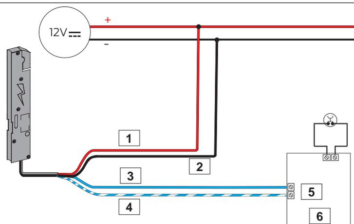
**Schema 3: esempio di collegamento del maniglione ad un citofono tramite relè ripetitore.**
