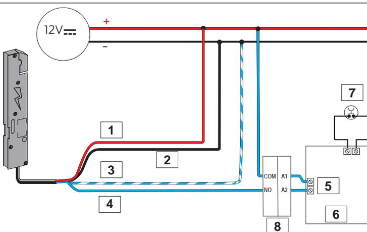
**Schema 4: Schema interfacciamento per stato maniglione (esempio installazione con attuatore di apertura e chiusura porta)**
